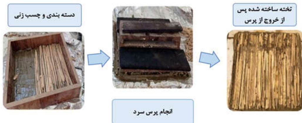
شکل ۲- مراحل ساخت پانل‌های آزمایشگاهی
