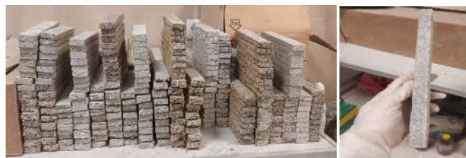
شکل ۲. نمونه‌های ساخته شده تخته‌های چوب سیمان
