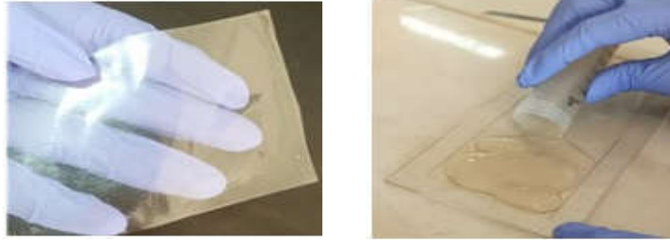
شکل ۱- قالب‌ریزی دوپ جهت تهیه فیلم (سمت راست) - فیلم سلولزی تولید شده (سمت چپ)
