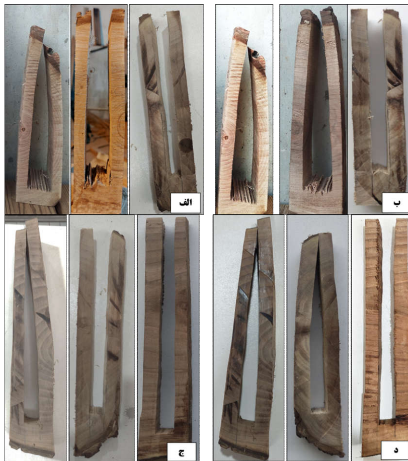
شکل ۵- نمونه‌های دوشاخه برش خورده از اسلب‌های خشک‌شده با برنامه اول (چپ)، برنامه دوم (وسط) و برنامه سوم (راست): الف) بلافاصله پس از برش در اسلب‌های با پهنای کم؛ ب) ۲۴ ساعت پس از برش در اسلب‌های با پهنای کم؛ ج) بلافاصله پس از برش در اسلب‌های با پهنای زیاد؛ د) ۲۴ ساعت پس از برش در اسلب‌های با پهنای زیاد.
