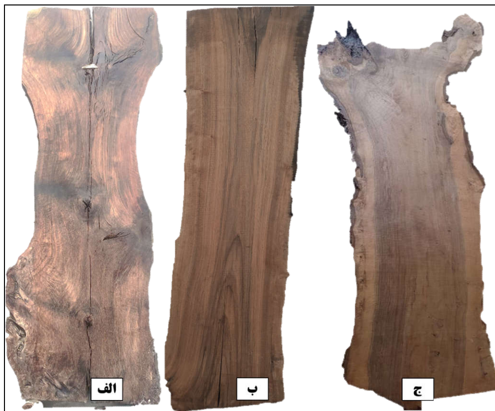
شکل ۷- ترک سطحی در اسلب‌های دارای پهنای زیاد خشک شده با برنامه اول (الف)، برنامه دوم (ب) و برنامه سوم (ج). وجود ترک‌های سطحی زیاد و پهن در اسلب مربوط به برنامه اول؛ ترک‌های سطحی و انتهای کمتر در اسلب مربوط به برنامه دوم، اسلب بدون ترک سطحی و مقطعی مربوط به برنامه سوم.
