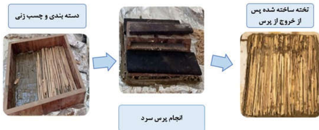
شکل ۲- مراحل ساخت پانل‌های آزمایشگاهی
