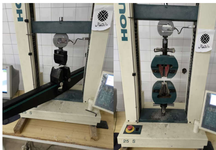
شکل ۳- انجام تست خمش و کشش
