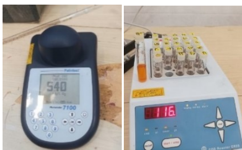
شکل ۳- دایجستر و اسپکتروفوتومتر مربوط به COD متر
