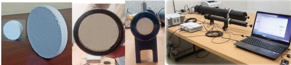
شکل ۱. نمونه‌های کوچک و بزرگ و دستگاه امیدانس تیوب و نحوه قرار دادن نمونه‌ی آزمونی کوچک و بزرگ در لوله امیدانس
