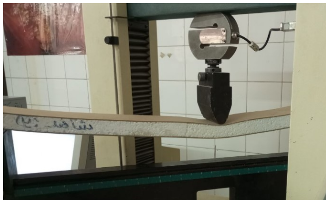
شکل ۲- آزمون تحت بارگذاری در دستگاه تست خمشی
