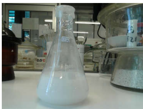
شکل ۲- سوسپانسیون نانو کریستال سلولز عامل‌دار شده با PDMS
