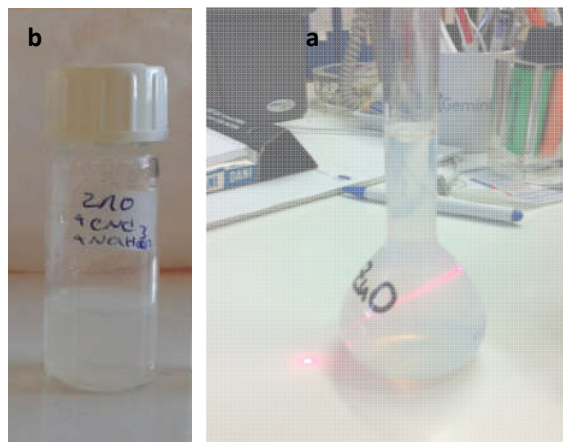
شکل ۴- (a) نانو اکسید روی، (b) سوسپانسیون نانو کریستال سلولز عامل دار شده با ZnO
