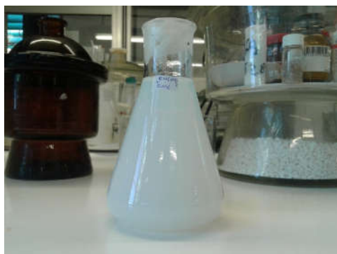
شکل ۳- سوسپانسیون نانو کریستال سلولز عامل‌دار شده با \text{Cu}(\text{OH})_2
