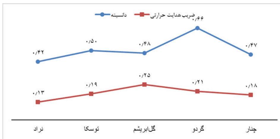
شکل ۴- بررسی مقدار دانسیته و ضریب هدایت حرارتی موجود در گونه‌های مورد بررسی
