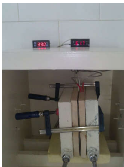
شکل ۱- نمای شماتیک و عکس دستگاه اندازه‌گیری ضریب هدایت حرارتی
