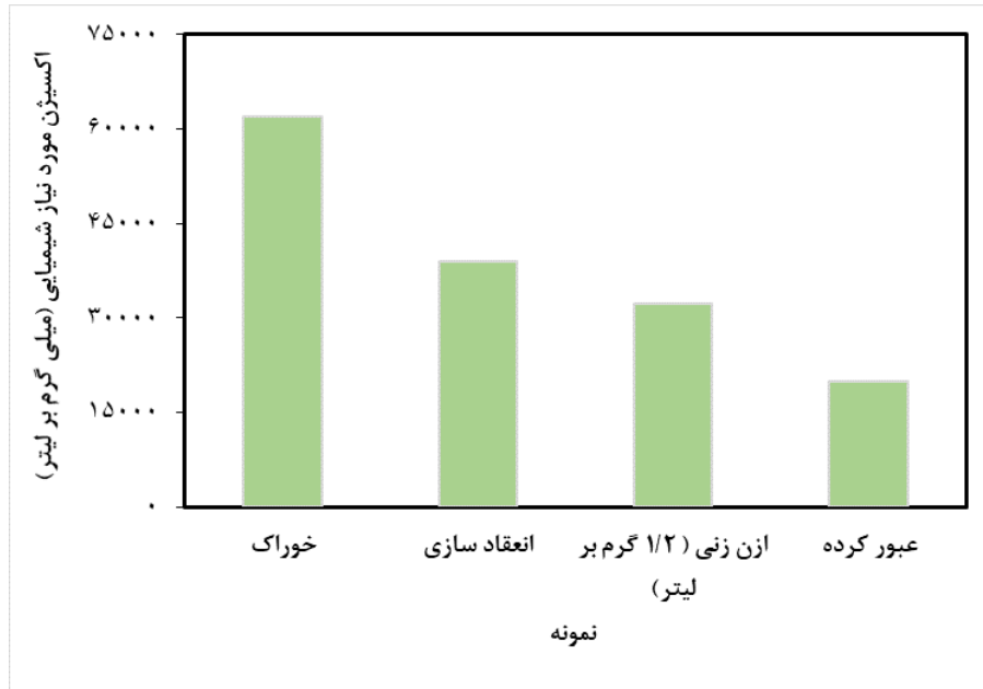
شکل ۱۰- COD های پساب خروجی از هر مرحله در فرایند ترکیبی انعقادسازی، ازن زنی و فیلتراسیون غشایی
