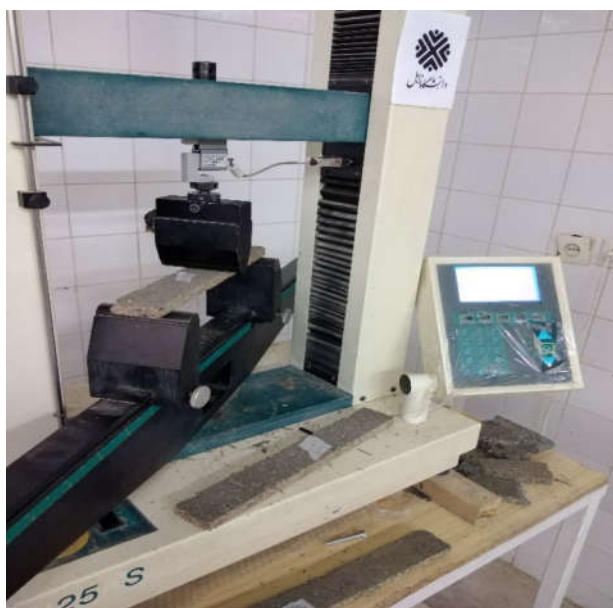
شکل ۳- آزمون خمش با دستگاه تست خمش استاتیک
