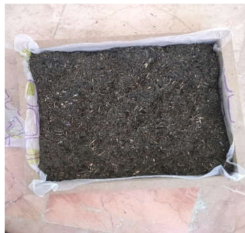
شکل ۲. الف: مراحل تشکیل کیک و پرس تخته الف: کیک خرده چوب سیمان در قالب ب: قالب قرار گرفته زیر پرس سرد
