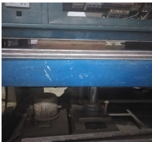
شکل ۲. الف: مراحل تشکیل کیک و پرس تخته الف: کیک خرده چوب سیمان در قالب ب: قالب قرار گرفته زیر پرس سرد
