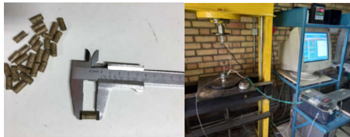
شکل ۱- دستگاه پلت پرس منفرد در مقیاس آزمایشگاهی و پلت تولید شده در شرایط بهینه.
