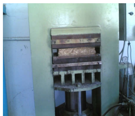
شکل ۲- کیک تخته خرده چوب پس از بیش پرس (چپ) و در پرس گرم (راست)
