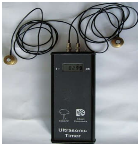
شکل ۳- دستگاه محاسبه زمان عبور امواج فراصوت
