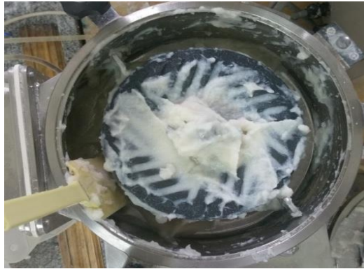
شکل ۲- تهیه میکروفیبریل سلولز با آسیاب دیسکی
