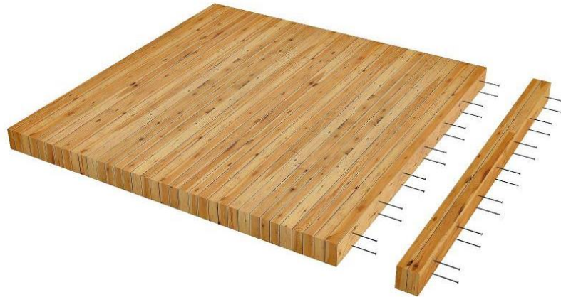
شکل ۱- طرح شماتیکی از پانل NLT و نحوه اتصال الوار چوبی با میخ
