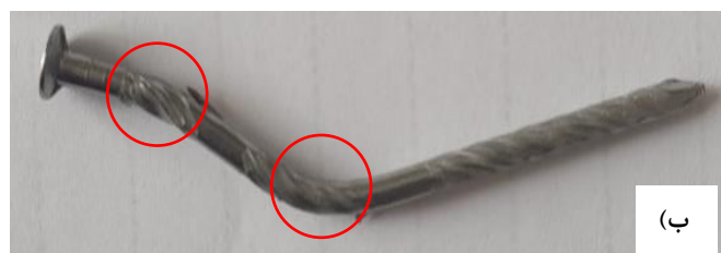
شکل ۶- الف) مد شکست III s تغییر شکل خمیری اتصال دهنده و له شدگی در عضو فرعی و اصلی (نزدیک صفحه برش)، ب) تغییر شکل خمیری اتصال دهنده
