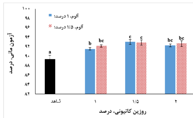
شکل ۶- ماتی کاغذهای تهیه شده از آهاردهی سوسپانسیون خمیرکاغذ الیاف بازیافتی با سطوح مختلف آلوم-روزین پراکنده (میله خطا Error bar روی ستون‌ها نشان دهنده میزان انحراف استاندارد می‌باشد)
