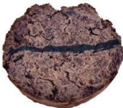
شکل ۴ - نمونه دایره‌ای شکل تهیه شده از انتهای ظروف چوبی پس از ۶ روز غوطه‌وری در آب
