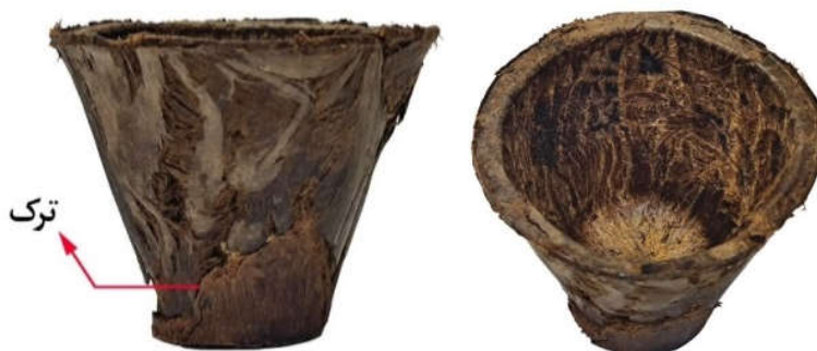
شکل ۵ - نمونه شکل گرفته به روش قالب گیری فشاری بعد از ۷۲ ساعت اشباع با محلول آب اکسیژنه
