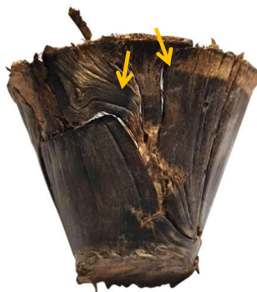
شکل ۳- محصول قالب‌گیری شده با نمونه‌های اشباع شده با پراکسید هیدروژن بعد از ۹۶ ساعت (ترک‌های گسترده و عدم یکپارچگی محصول نهایی)
