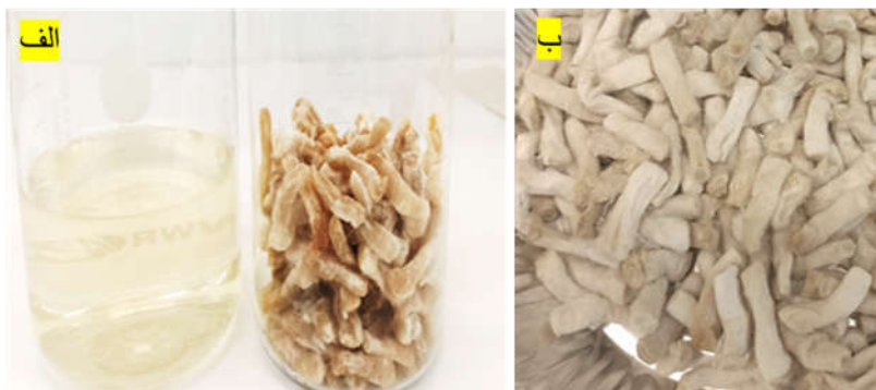
شکل ۲- الف- تصویر فیلترهای سیگار شسته شده و مایع آب‌گیری شده از الیاف فیلتر سیگار پس از شست‌وشوی نهایی و ب- تصویر الیاف فیلتر سیگار خشک شده
