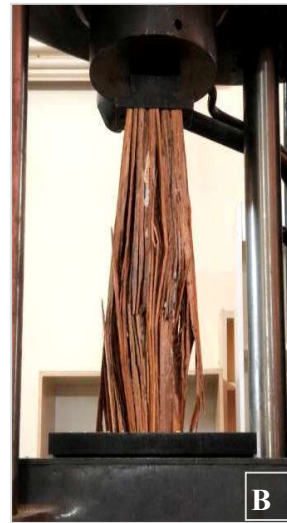
شکل ۷- مقاومت فشاری موازی الیاف (A) در تیرهای لایه‌ی ساخته‌شده با LSL، متأثر از نوع گلولام و چسب مصرفی، تصویری از آزمون فشار موازی الیاف (B)
