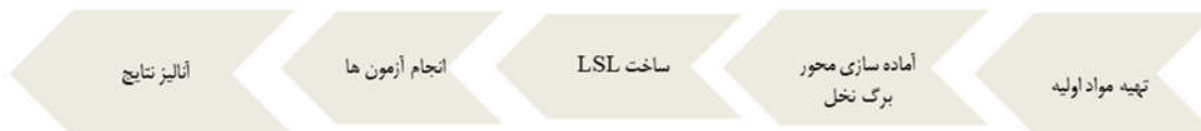
شکل ۱: طرح شما تیک از آماده سازی و ساخت LSL از محور برگ نخل
