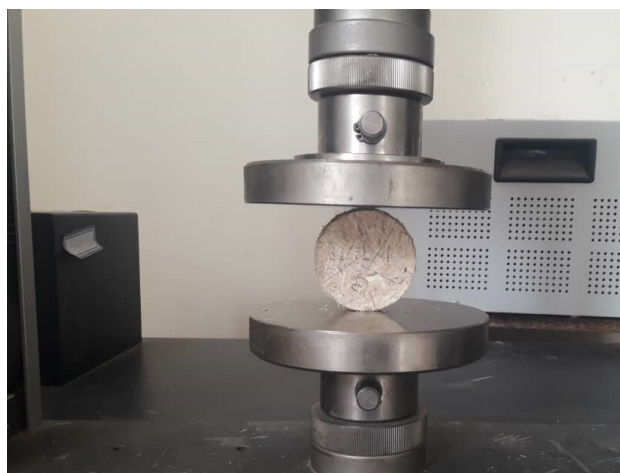
شکل ۱- نحوه قرار گیری نمونه در دستگاه اندازه گیری مقاومت فشاری
