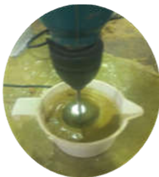
شکل ۵- اختلاط رزین و ترکیبات ژئولیت
