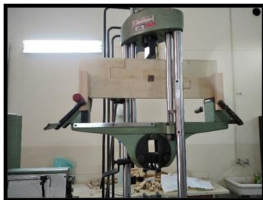
شکل ۵- تیر باربر تحت آزمون خمش در صفحه
