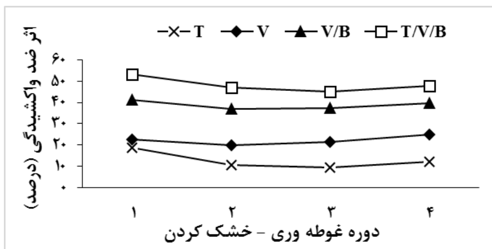
شکل ۸- اثر سطوح مختلف اصلاح بر کارایی ضد واکشیدگی طی آزمون دوره‌ای غوطه‌وری - خشک کردن
