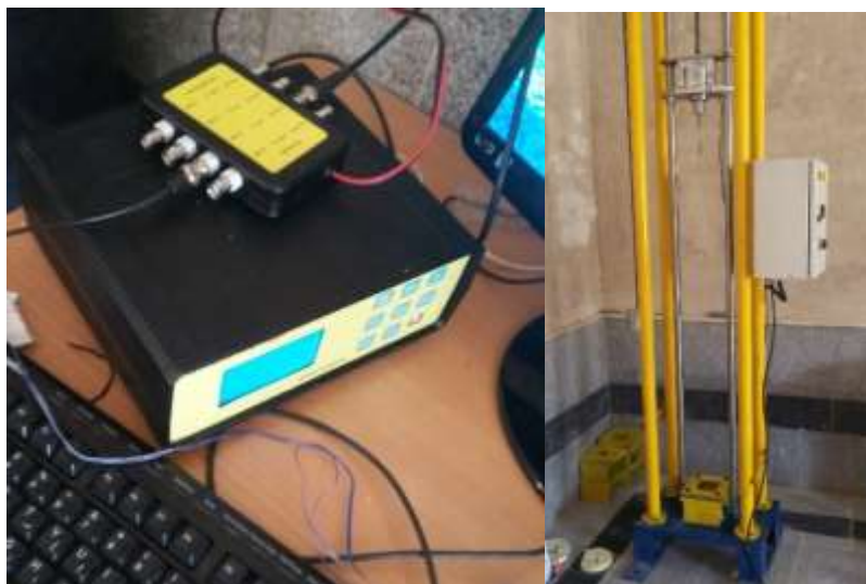
شکل ۳ - دستگاه ضربه سقوط آزاد دانشگاه تفرش
