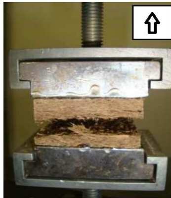
شکل ۱- تصویر آزمون چسبندگی داخلی [۱۳]
