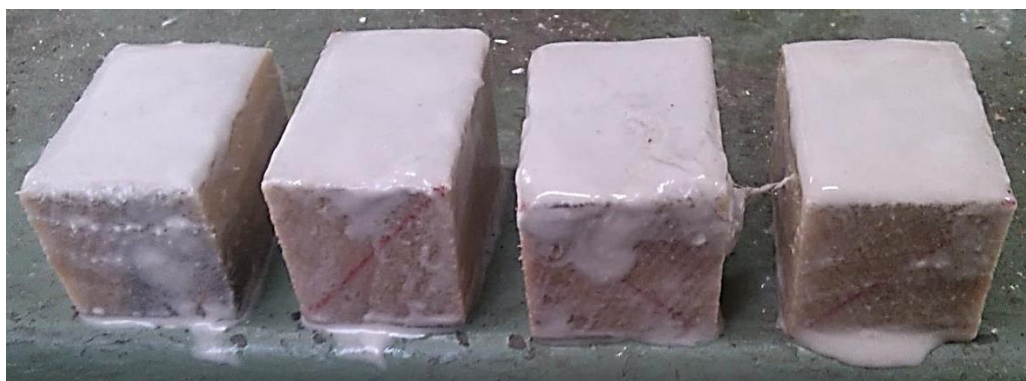
شکل ۱- نمونه‌های اشباع‌شده با نانو ولاستونیت، نانو ولاستونیت به رنگ سفید بر روی سطح نمونه‌ها مشاهده می‌شود
