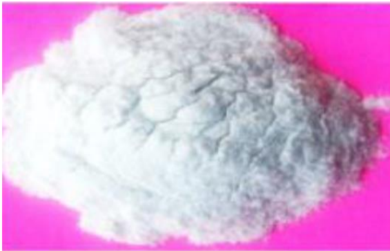
شکل ۳- نمونه کربوکسی متیل سلولز آسیاب شده تولیدی از خمیر رنگبری شده سودای باگاس
