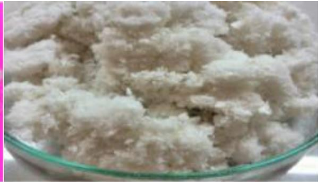
شکل ۱- نمونه کربوکسی متیل سلولز تولید شده از خمیر رنگبری- شده سودای باگاس قبل از آسیاب
