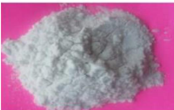
شکل ۴- نمونه کربوکسی متیل سلولز آسیاب شده تولیدی از خمیر DIP کاغذهای باطله اداری
