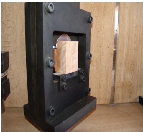
شکل ۴- نمونه‌های برش موازی الیاف و شکاف خوری
