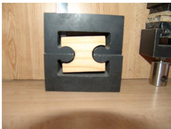
شکل ۳- نمونه آزمایش کشش موازی الیاف و مقاومت به خروج میخ
