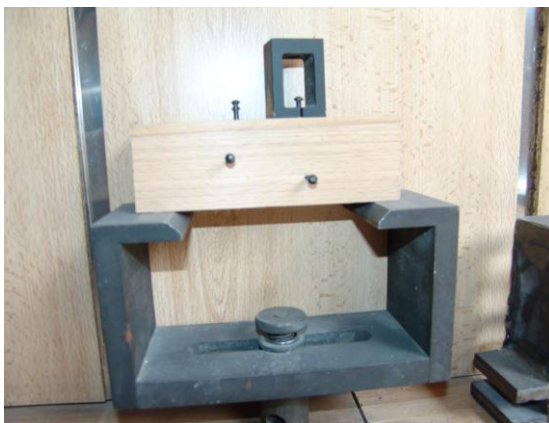
شکل ۳- نمونه آزمایش کشش موازی الیاف و مقاومت به خروج میخ
