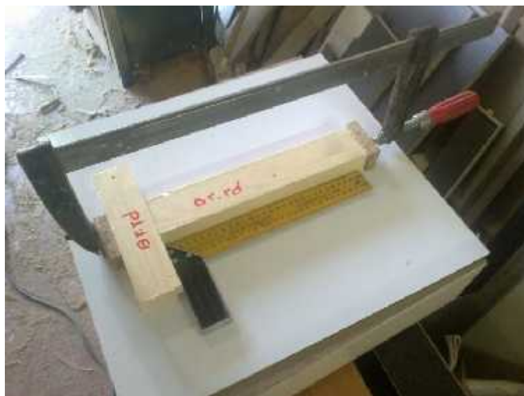
شکل ۲- نحوه گیره بستن اتصال برای عمل کردن چسب
