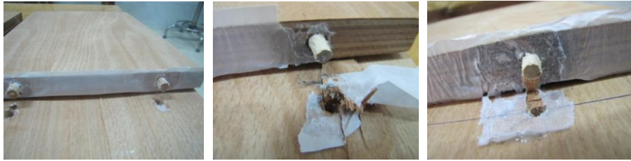
شکل ۹- کشیده شدن بین و جدا شدن لایه‌ها در عمق نفوذ ۹ و ۱۳ میلی‌متر
