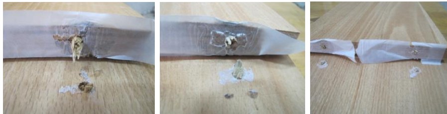
شکل ۱۰- شکست بین در عمق نفوذ ۱۷ میلی‌متر
