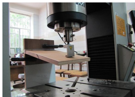
شکل ۴- نحوه بارگذاری اتصال T شکل
