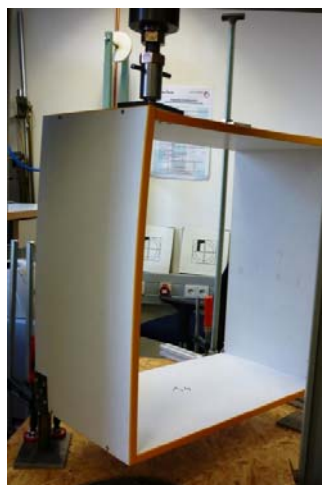
شکل ۲: یک جعبه روکش ملامینه و لبه چسبان شده در حال آزمون استاتیکی اعمال بار
