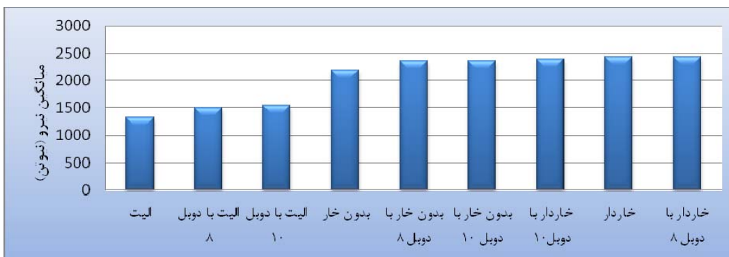
شکل ۶، مقایسه میانگین مقاومت اندازه اتصال جداشدنی
