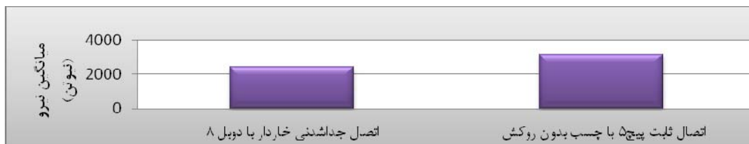
شکل ۸، مقایسه میانگین مقاومت اتصال جداشدنی و ثابت
