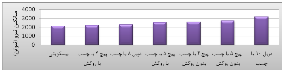
شکل ۷، مقایسه میانگین مقاومت اتصال ثابت
