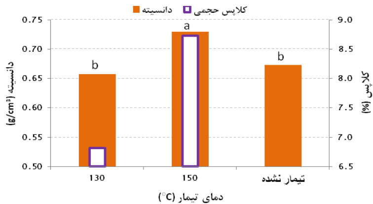
شکل ۲- اثر دمای تیمار گرمایی بر چگالی و چین خوردگی حجمی چوب راش؛ حرف‌های a و b نشان دهنده گروه بندی دانکن به ترتیب بزرگ‌ترین و کوچک‌ترین مقادیر چگالی می‌باشند.
