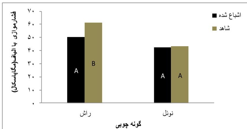
شکل ۱۵- اثر متقابل گونه چوبی و اشباع با محلول نانوقره بر مقاومت فشار موازی با الیاف
