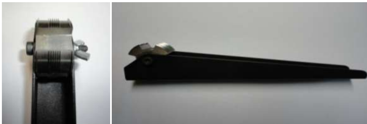
شکل ۱- دستگاه آزمون Cross-Cut
