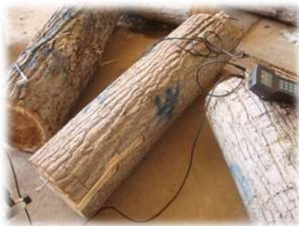
شکل ۲- اندازه‌گیری در جهت طولی در گرده‌بینه‌های استحصالی از درختان نمونه
