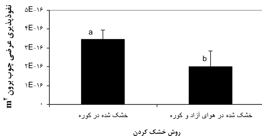
شکل ۵- میانگین نفوذپذیری عرضی چوب برون بلوط خشک‌شده در کوره و روش ترکیبی (هوای آزاد و کوره)
