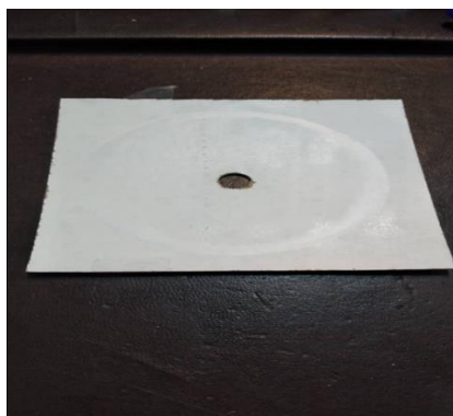
شکل ۲۰- نمونه روکش ملامینه شده تحت آزمون مقاومت به سایش
