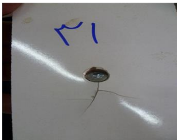
د): فرو رفتن سر پیچ در عضو فرعی در پیچ با قطر ۶
