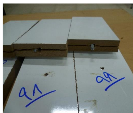
ج): شکست پیچ (بریدن) در محل اتصال دو عضو اتصال
