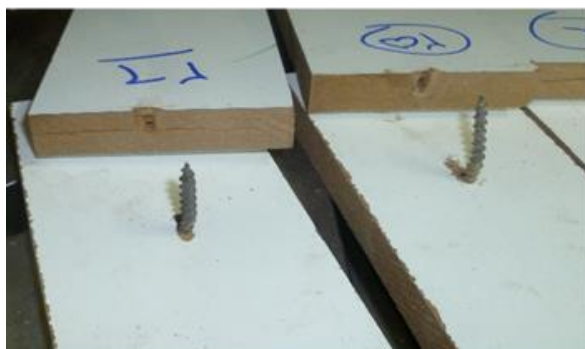
ب): لپیدگی و شکاف توام
