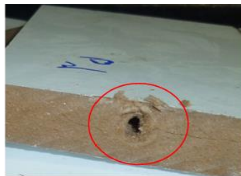
الف): مشارکت لایه رویی و مغزی در برابر بار برشی
