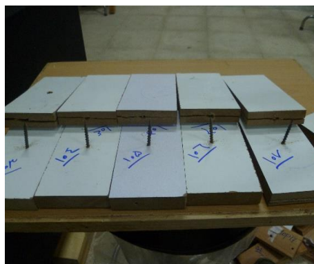
الف): مد شکست اتصال با پیچ ۴/۲ میلی‌متر
