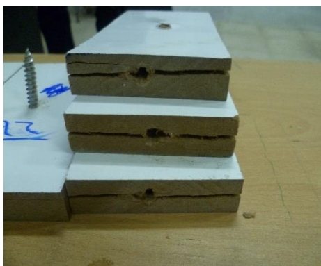
ب): شکاف در عضو اصلی اتصال با پیچ به قطر ۵ میلیمتر
