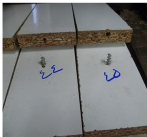
ج): شکست پیچ (بریدن) در محل اتصال دو عضو اتصال
