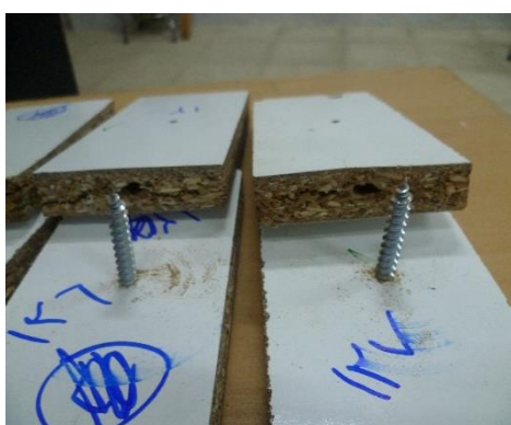
د): تنش لهدگی و شکاف کم در قسمت پایینی تخته
