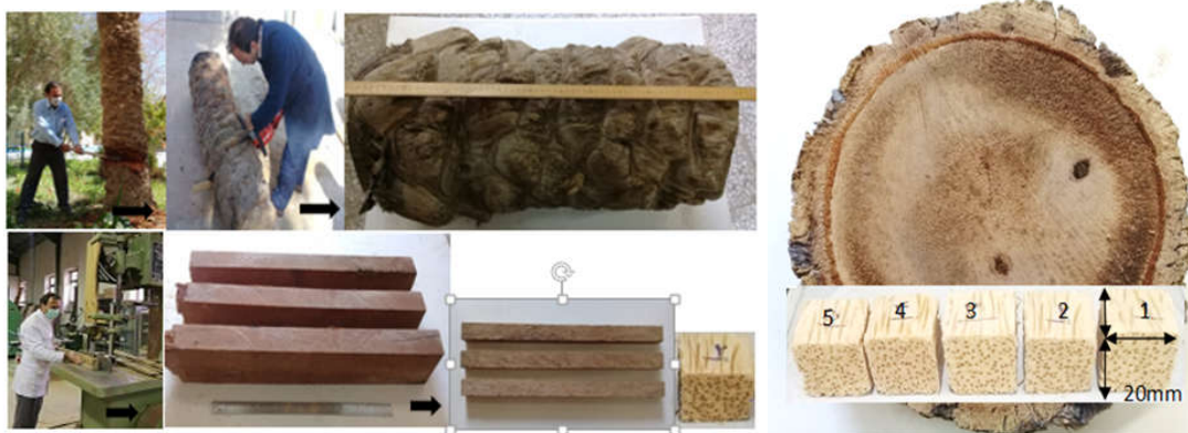
شکل ۱- مراحل تبدیل تنه نخل خرما به نمونه‌های آزمایشگاهی
