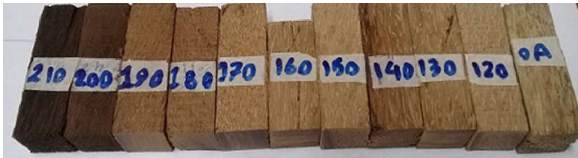
شکل ۲- نمونه‌های آزمایشگاهی اصلاح حرارتی بافت نخل خرما
