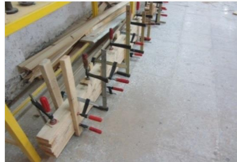
شکل ۴- اتصال لایه‌های چوبی توسط چسب و گیره مکانیکی و مهار شدن دو سر تیر توسط قاب فولادی
