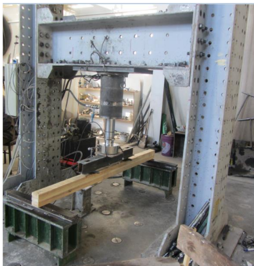
شکل ۵- روش بارگذاری تیرهای گلولام در اندازه واقعی
