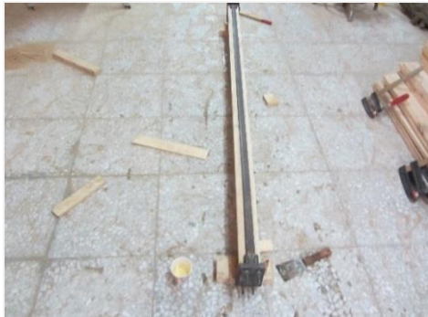
شکل ۴- اتصال لایه‌های چوبی توسط چسب و گیره مکانیکی و مهار شدن دو سر تیر توسط قاب فولادی
