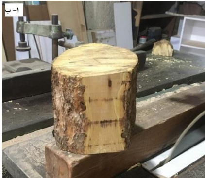
شکل ۱- الگوهای برش و تعداد نمونه آزمونی در ارتفاع مختلف ساقه درخت (۱- الف) و تبدیل ساقه درخت انار به دیسک ۵ سانتی‌متر (۱- ب).
