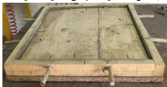
شکل ۱- قالب جهت ساخت تخته خرده چوب سیمان
