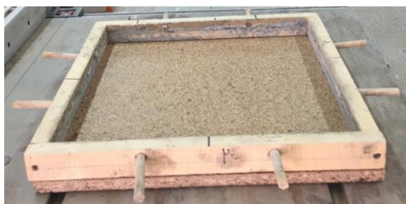
شکل ۱- قالب جهت ساخت تخته خرده چوب سیمان
