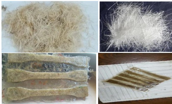
شکل ۱- الیاف و نمونه‌های آزمونی از ماتریس و کامپوزیت. (الف) الیاف شیشه، (ب) الیاف کنف، (ج) قالب سیلیکونی برای نمونه‌های آزمون ضربه و انرژی شکست ماتریس به همراه نمونه‌های آزمونی آزمون تنش- کرنش ماتریس، (د) نمونه‌های آزمونی آزمون تنش- کرنش کامپوزیت آلیاژ/الیاف کنف.
