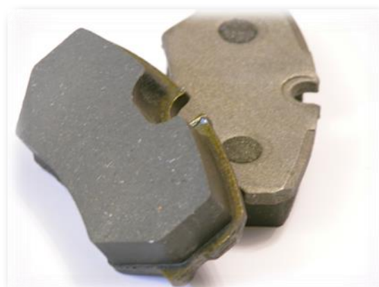
شکل ۲. تصویر نمونه لنت‌های ساخته شده
