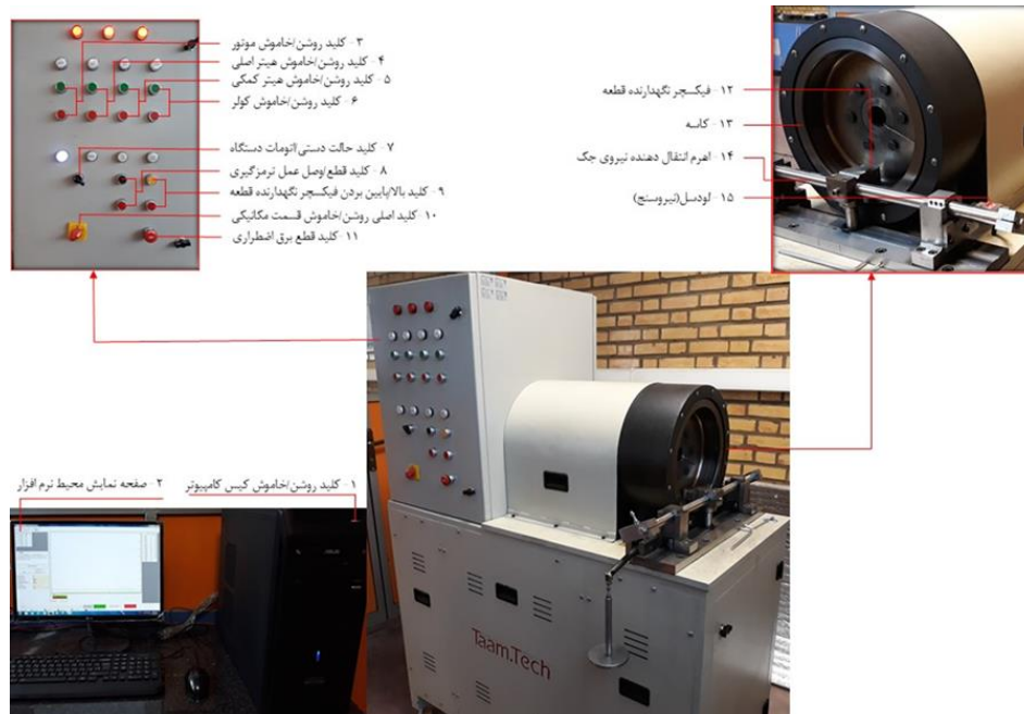
شکل ۴. دستگاه آزمون سایش و اصطکاک لنت ترمز
