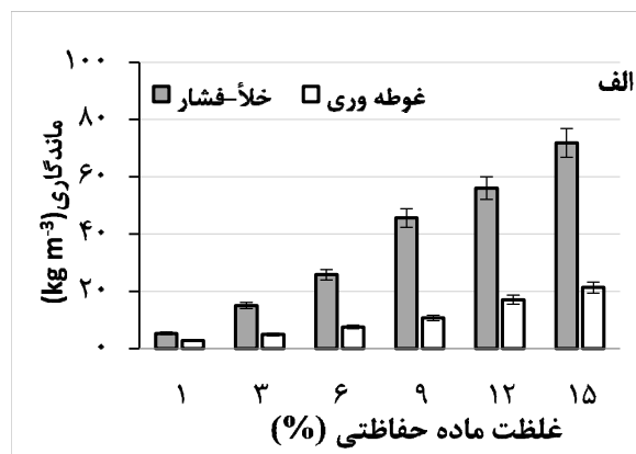
شکل ۲- اثر تغییرات غلظت شیره درخت پسته وحشی بر میزان ماندگاری (الف) و درصد افزایش وزن (ب) در دو روش خلاء-فشار و غوطه‌وری
