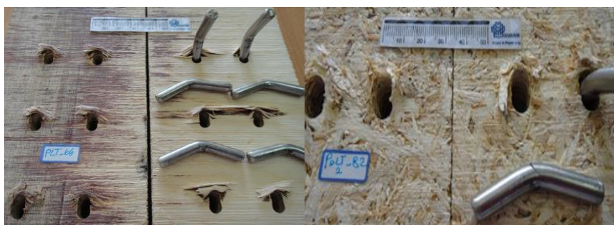
شکل ۱۴- مد شکست II در اتصالات با ۳ پین ۶ میلی متری (تصویر راست) و ۱ پین ۸ میلی متری در ردیف (تصویر چپ)
