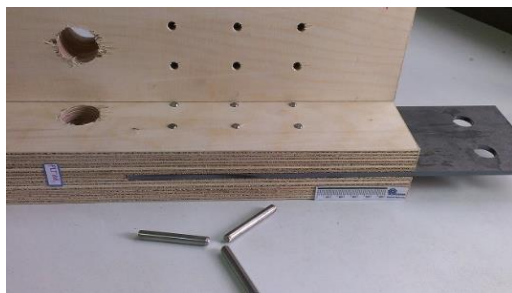
شکل ۶- نمونه‌های آزمون اتصالات دوگانه برشی جهت انجام آزمون ظرفیت تحمل بار
