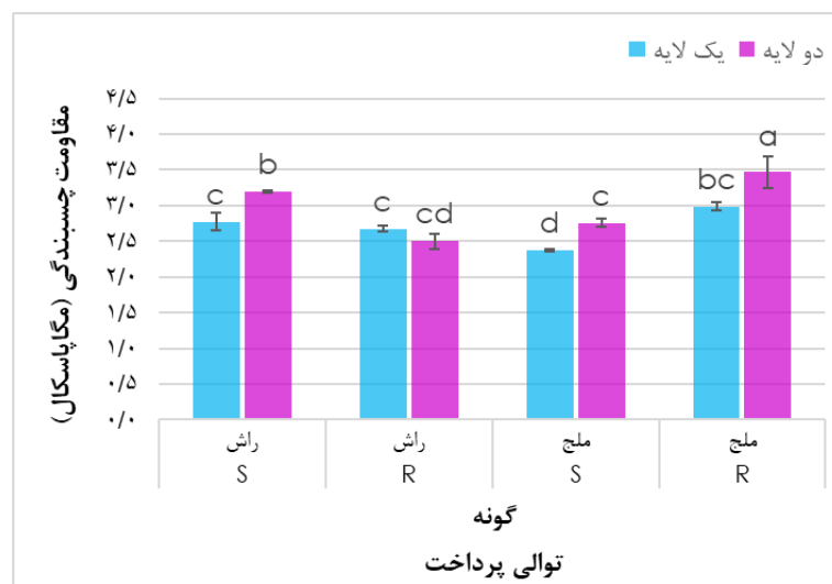
شکل ۵- اثر متقابل نوع روکش، توالی پرداخت و ضخامت پوشش بر مقاومت چسبندگی
