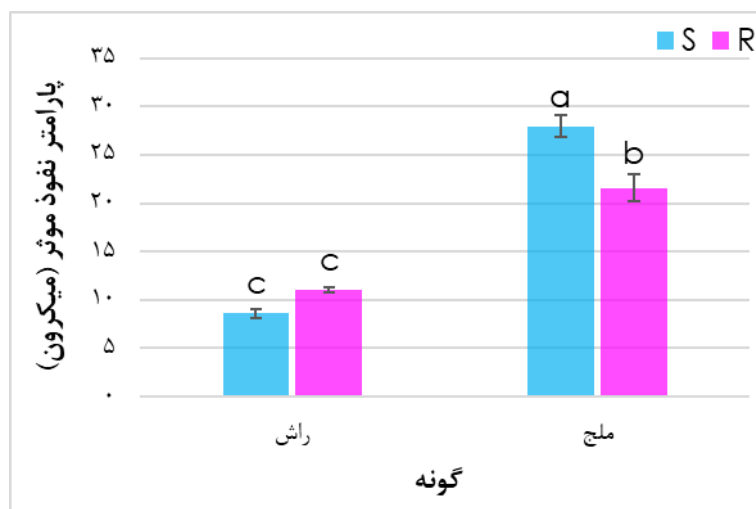
شکل ۸- اثر متقابل نوع روکش و توالی پرداخت بر پارامتر نفوذ مؤثر
